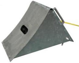
Der Sicherheits-Radkeil PZK gewährleistet ein durchgehendes Sicherheitskonzept beim Be- und Entladen von Lkw an der Laderampe. Er ist mit einem lageabhängigen Ultraschall-Sensor versehen und über ein robustes Kabel mit der Brückensteuerung verbunden. Sobald eines der Lkw-Hinterräder mit dem Sicherheits-Radkeil abgesichert ist, wird die Brückensteuerung „freigeschaltet“ - die Überladebrücke kann erst jetzt betätigt werden.
