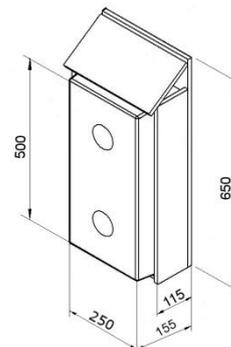
Le butoir en capot protection est proposé pour des quais fortement sollicités. Grâce à la plaque penchée le butoir est protégé contre les détériorations plus graves. Grâce aux guidages latéraux en acier plat les vis de fixation des butoirs sont parfaitement protégées contre le cisaillement.
