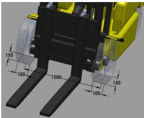
Le niveleur intégré à lèvre basculante (modèle PS2) répond entièrement aux exigences de la norme européenne EN 1398. La capacité de charge standard de 60 kN (charge axiale dynamique) est conforme aux exigences de la norme EN 1398 pour la surface de contact de roue de 100x150 mm. Des niveleurs ayant des charges ponctuelles et des capacités de charge plus élevées sont également disponibles à court terme.
