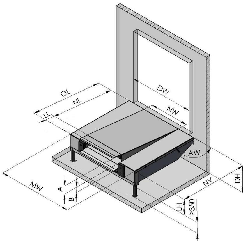
Selon la norme EN 1398 l'utilisation du niveleur n'est pas autorisée en dépassant la pente admissible de  $\pm 12,5\%$  (env.  $\pm 7^\circ$ ). La valeur indiquée ne peut être dépassée que si l'utilisateur exclut tout risqué de glissement (p. ex. Par des surfaces sèches et propres).
