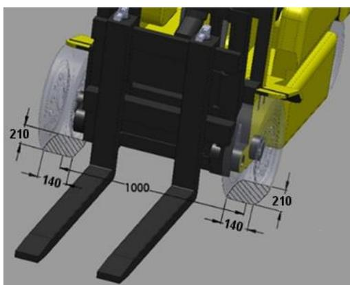
Le niveleur à lèvre basculante (modèle PS2) répond entièrement aux exigences de la norme européenne EN 1398. La capacité de charge standard de 120 kN (charge axiale dynamique) est conforme aux exigences de la norme EN 1398 pour la surface de contact de roue de 140 x 210 mm. Des niveleurs ayant des charges ponctuelles et des capacités de charge plus élevées sont également disponibles à court terme.
