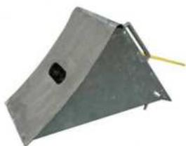
Der Sicherheits-Radkeil PZK gewährleistet ein durchgehendes Sicherheitskonzept beim Be- und Entladen von LKW an der Laderampe. Er ist mit einem lageabhängigen Ultraschall-Sensor versehen und über ein robustes Kabel mit der Brückensteuerung verbunden. Sobald eines der LKW-Hinterräder mit dem Sicherheits-Radkeil abgesichert ist, wird die Brückensteuerung „freigeschaltet“ - die Überladebrücke kann erst jetzt betätigt werden.
