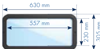
Abgerundete Ecken ( r = 60 \text{ mm} ), hoher Isolierungswert
